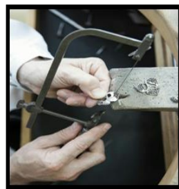
شكل رقم (10) التشكيل بالتفريغ https://pin.it/mxexrbfbidqc2z
