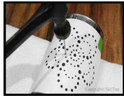
شكل رقم (8) الثقب بالسنيك https://pin.it/d5jimiaumyz35k
